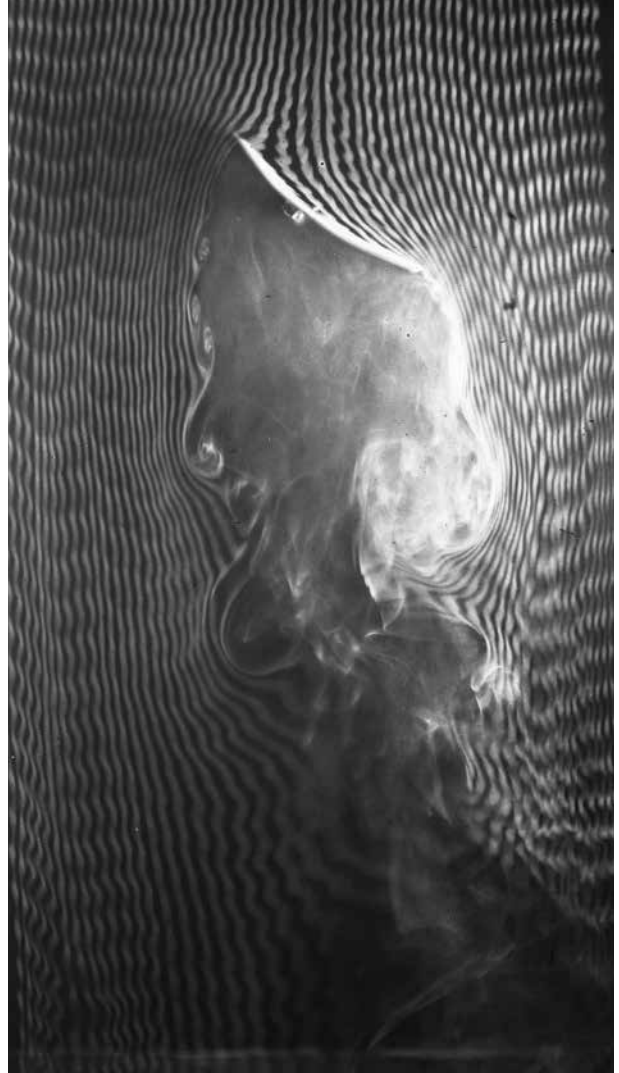
Mouvements de l'air rencontrant une surface courbe inclinée, chronophotographie sur plaque fixe, Étienne-Jules Marey, 1901, DR
