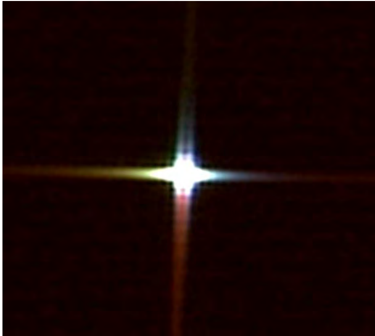
Chromatisme dû à un mauvais alignement des lentilles.
