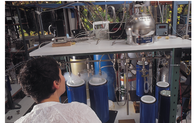
Fig. 2 – Éléments d'un système analytique de préconcentration des gaz piégés dans la glace au LGGE, en vue de l'analyse des rapports isotopiques. © L. Médard, photothèque CNRS ■
