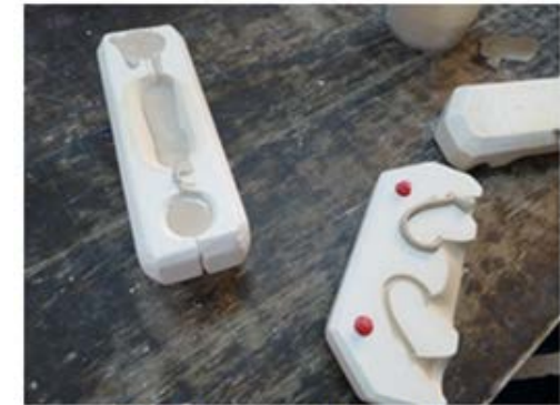
Coulage en moule de plâtre
