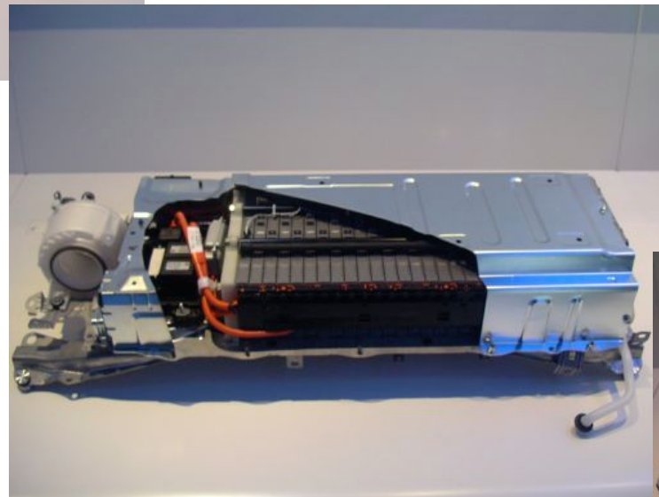
2009, HEV, NiMH 1,3 kWh 100 kW l-h-p = 100x25x35 cm 3 ? 620.000 ventes
