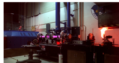
Laser à CO 2 continu 50kW
