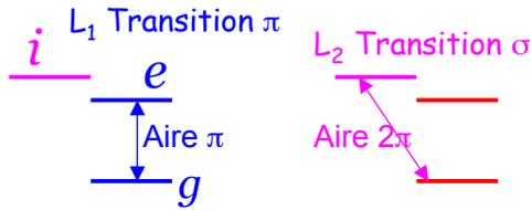
Chaque ion possède 2 états ( $g, e$ ) codant le qubit et un niveau auxiliaire  $i$ . Les transitions  $g \rightarrow e$  sont en polarisation  $\pi$  et  $g \rightarrow i$  en  $\sigma$ . Les ions vibrent ensemble dans le piège (mode du centre de masse).
