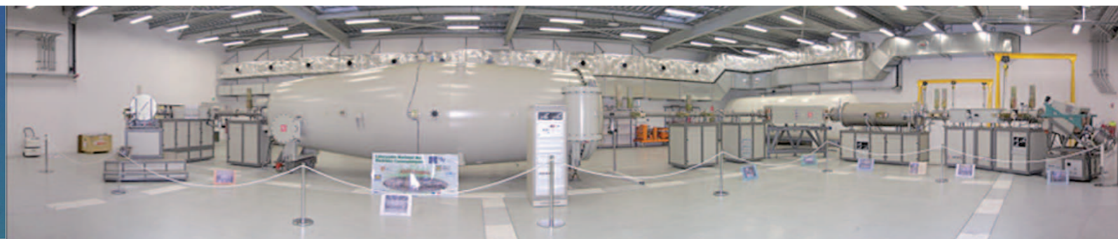
3. Spectromètre ASTERisques (Accélérateur pour les Sciences de la Terre et les Risques) déjà installé sur le campus du CEREGE. Le projet EQUIPEX concerne l'installation d'une nouvelle source d'ions plus performante (ici, à gauche). Photo : G. Aumâtre, CEREGE
