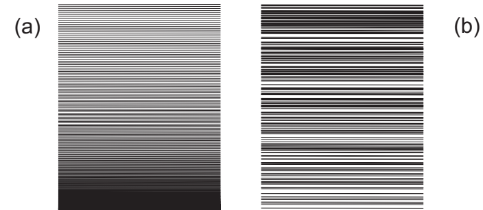
FIGURE 10. Énergie des 100 premiers états à une particule dans une boîte à une dimension (gauche) et à trois dimensions (droite) [unité arbitraire en énergie].
