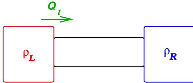
Dans le cas où la partie droite et la partie gauche comportent des réservoirs de particules comme sur la figure, le système atteint un régime stationnaire où, pour  $t$  grand,  $\langle Q \rangle_V$  et  $\langle Q^2 \rangle_0$  augmentent linéairement avec  $t$
