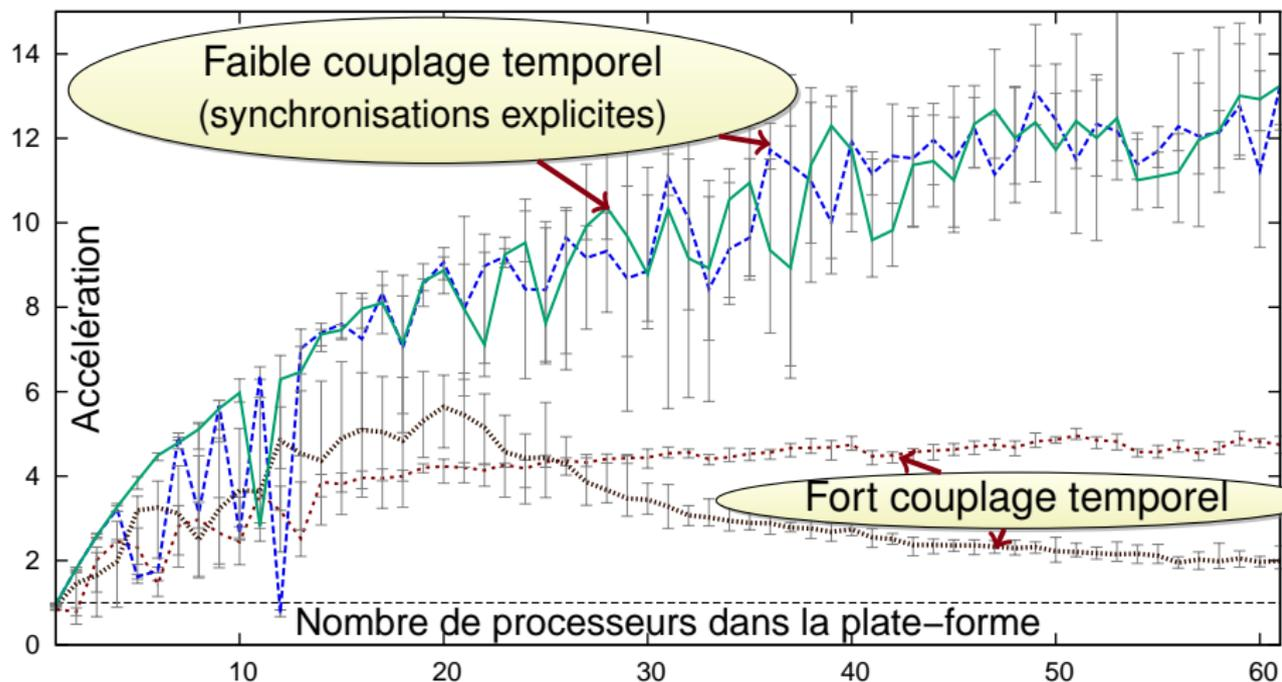
Machine de test :  $4 \times 12 = 48$  cœurs
