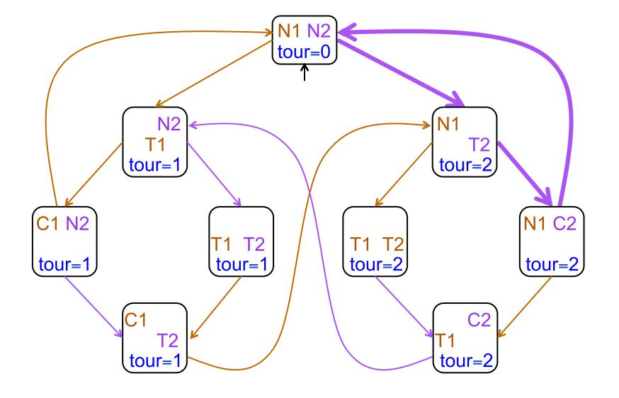
□ C1 : J1 entre infiniment souvent en section critique FAUX à cause de la boucle en haut à droite
