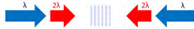
FIGURE 6. Principe de la réalisation d'un super-réseau, avec la superposition de deux ondes lumineuses stationnaires, l'une à la longueur d'onde \lambda et l'autre à la longueur d'onde 2\lambda .
