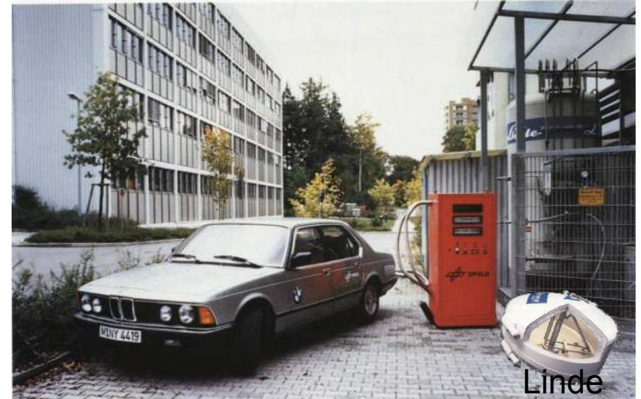
Station d'H<sub>2</sub> liquide: remplissage d'une BMW 745i
