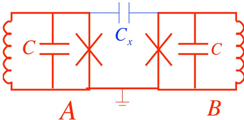
Les qubits de phase A et B sont identiques. On les couple par une capacité  $C_x$  très petite devant la capacité  $C$  des jonctions. Les tensions  $V_A$  et  $V_B$  aux bornes de  $C_x$  sont égales à  $2ep_a/C$  et  $2ep_b/C$  respectivement ( $p_a$  et  $p_b$  sont les charges ou « impulsions canoniques » des deux circuits), d'où l'énergie de couplage induite par  $C_x$ :
