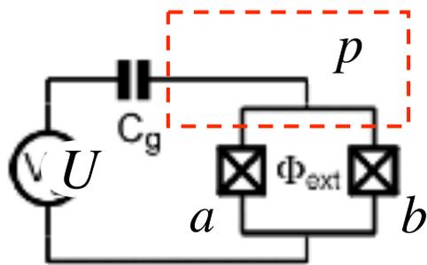
On remplace la jonction unique par deux jonctions (a) et (b) dans une boucle de type SQUID. La boîte de Cooper (rectangle pointillé rouge) est maintenant limitée par la capacité  $C_g$  et les deux jonctions (capacité totale  $2C_J$ ). Le flux  $\Phi_{ext}$  à travers la boîte module le courant (voir leçon 2, & II-B) et le Hamiltonien du qubit devient:
