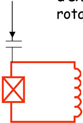
Un courant alternatif  $-I_{rf} \sin(\omega t - \varphi)$  de fréquence voisine de  $\omega_{01}$  permet d'exciter le qubit à travers une capacité et de réaliser des opérations de rotation de son vecteur de Bloch. Le hamiltonien du qubit devient:
