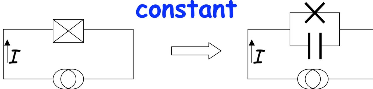
Supposons que la jonction décrite à la leçon 2 est alimentée par une source de courant constant  $I$ . La conservation du courant dans le circuit équivalent s'écrit en exprimant les lois de Josephson dc et ac:
