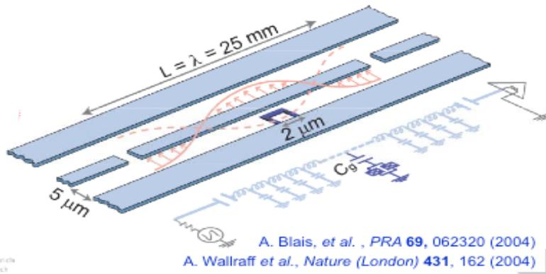
stationnaire. Le résonateur à capacité et inductance réparties se modélise comme un réseau de circuits LC en série (voir Fig). Le volume  $V_r \sim Lb^2$  ( $L=25\text{mm}$  et  $b$  dimension transversale  $\sim 5\mu\text{m}$  de la ligne) est  $\ll \lambda^3$ , d'où un très grand champ électrique par photon. Le qubit, inséré dans le résonateur, est
