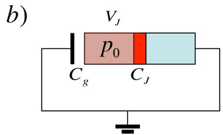
Considérons d'abord le cas  $U = 0$  (fig b).  $C_J$  et  $C_g$  sont alors en parallèle entre la boîte au potentiel  $V_J$  et la masse. La charge  $2ep_0$  de la boîte est celle de deux capacités dont les valeurs s'ajoutent:
