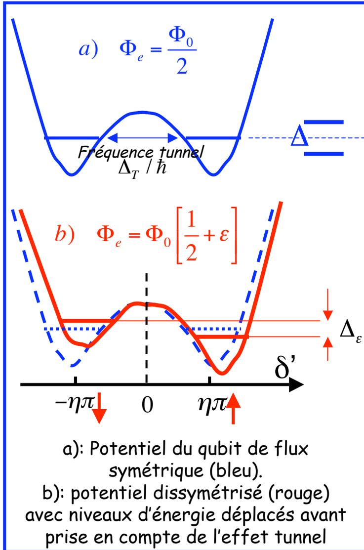
Pour  $\Phi_e = \Phi_0/2$ , les états d'énergie du qubit sont les combinaisons symétrique et antisymétrique des états fondamentaux des 2 puits. Leur énergie diffère d'une quantité  $\Delta_T$ ,  $\hbar$  fois la fréquence de l'effet tunnel à travers la barrière entre les puits. [Note: ne pas confondre l'effet tunnel de l'observable macroscopique  $\delta$  avec celui des paires de Cooper de la JJ].
