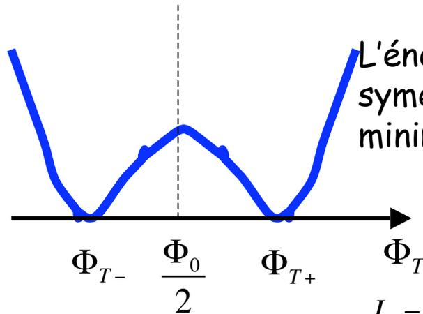
L'énergie potentielle du qubit en fonction de  $\delta'$  (resp.  $\Phi_T$ ) est symétrique autour de l'axe  $\delta' = 0$  (resp.  $\Phi_T = \Phi_0/2$ ) avec 2 minima pour:
