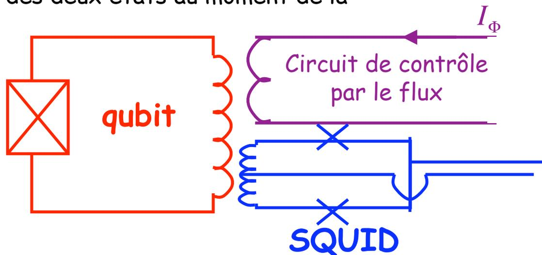
Schéma de principe du qubit de phase avec son circuit de contrôle par le flux et le SQUID de détection.
