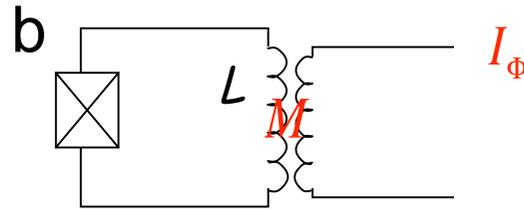
Au lieu de contrôler le qubit par un courant dc, on peut le faire de façon inductive par un flux magnétique  $\Phi_e$  envoyé à travers le circuit (fig. a).
