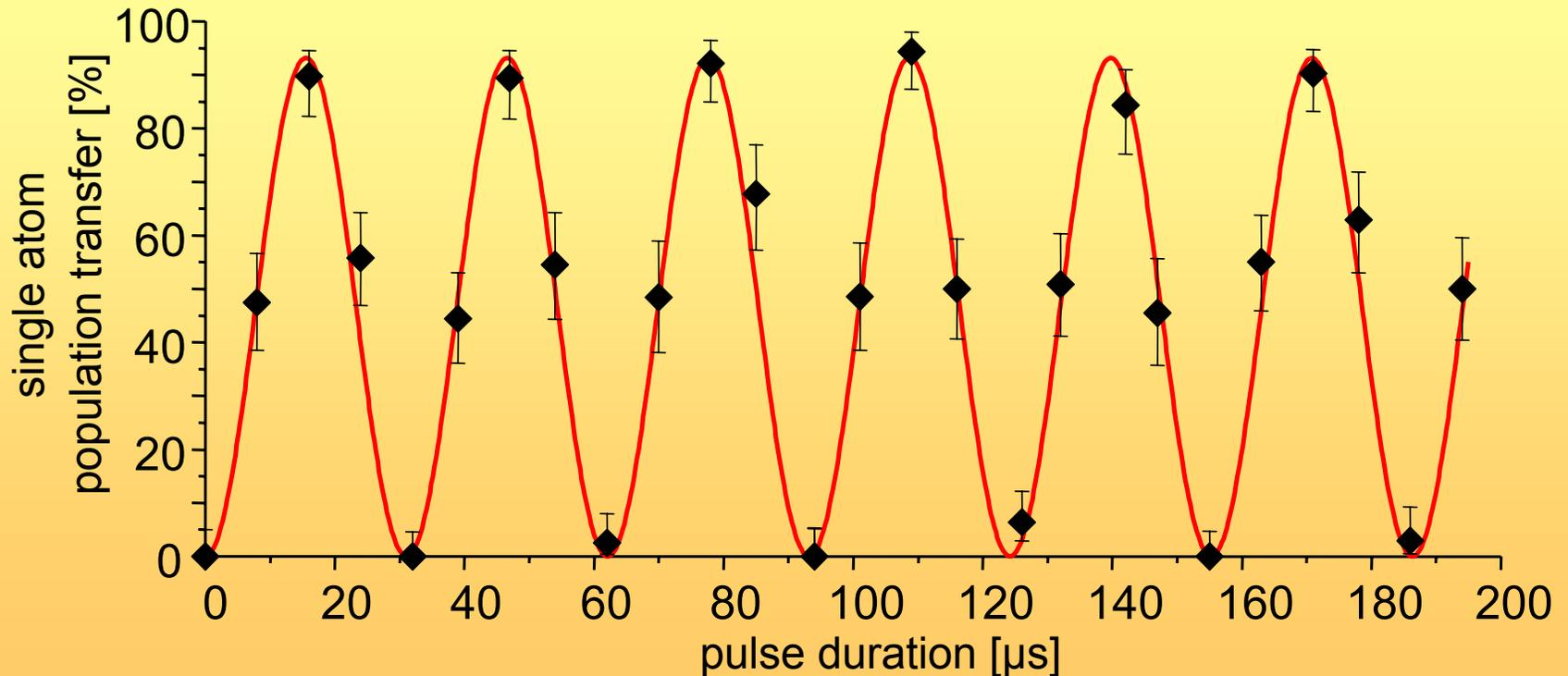
Coherence time  $T_2 > 600 \mu\text{s}$
