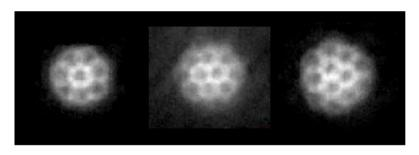
Réseau de vortex obtenus en faisant tourner le condensat (Dalibard et al, ENS, 2000)
