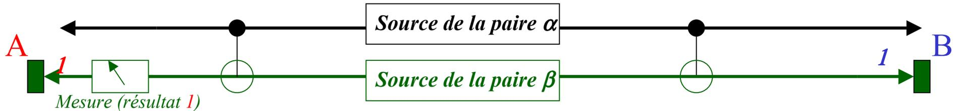
Portes C-NOT locales en **A** et **B**. Les qubits  $\alpha$  sont sources,  $\beta$  cibles. Le qubit  $\beta$  de **A** est mesuré (résultat **1**), puis la **paire  $\beta$**  jetée: la **paire  $\alpha$**  aboutit dans un état d'intrication maximale:
