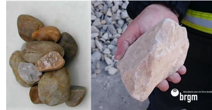
Gauche : galets de quartz ultrapur de calibre 60-120 mm Droite : fragment de grès siliceux induré
