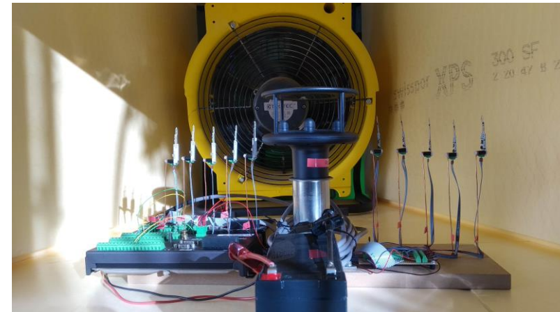
Banc de calibrage de micro-anémomètres (photo R.Camponovo)
