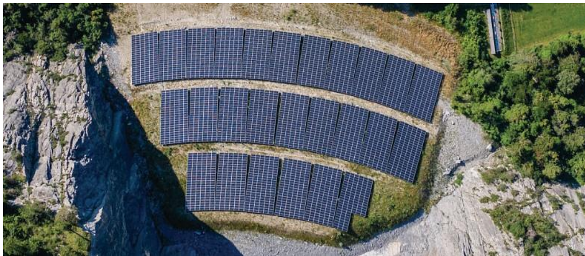
Centrale solaire sur ancienne carrière, Felsberg (GR). 7'400 m 2 , 1500 kWp, 1'585'000 kWh/a. Diplôme Prix Solaire Suisse 2021.
