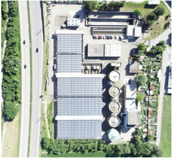
Centrale solaire pliante sur bassins station d'épuration, Coire (GR). 5'900 m 2 , 640 kWp, 540'000 kWh/a. Prix Solaire Suisse 2019.
