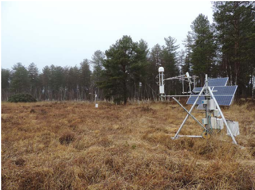
Station Eddy-covariance LICOR LI-7200RS de la tourbière de la Guette.
